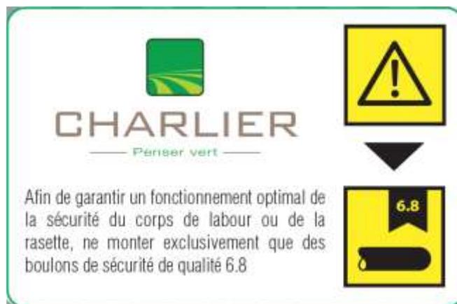
Sur les rasettes, procédez de même. Remettez obligatoirement un boulon **NEUF** M 12x50 (clé de 19) de classe 6.8 et serrez-le au couple prescrit dans le tableau page 30. Le repère A de la figure 16 vous indique l'emplacement du boulon de sécurité.
