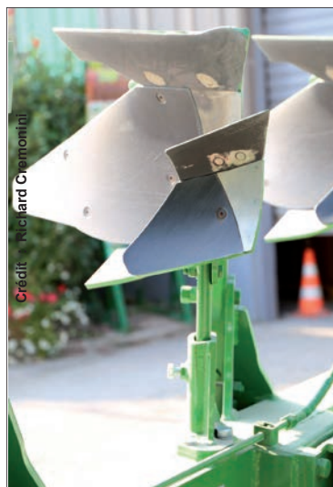
La suppression de la rasette labour laisse place au déflecteur surmonté d'une étrave couteau en version déchaumage.
