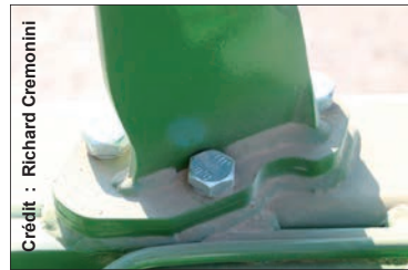
Trois boulons pour passer du déchaumage au labour.
