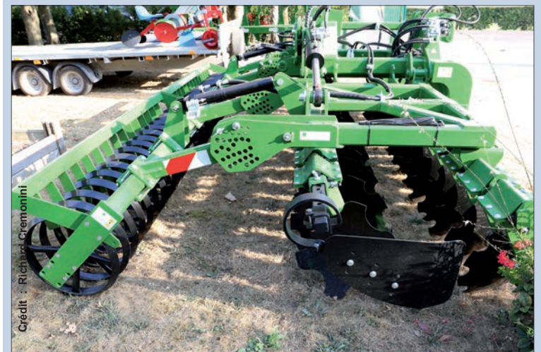
Le déchaumeur à disques en version frontale d'un poids de 2 550 kg.
