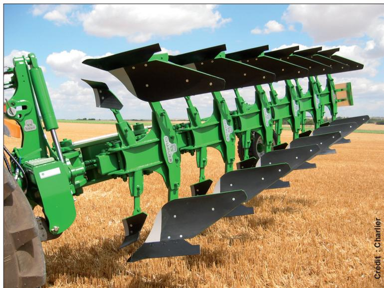
Dans la gamme, on trouve de la portée de 4 à 7 corps, de la poussée de 3 à 5 corps, de la charrue monoroue de 7 à 10 corps, de la charrue semi-portée de 8 à 12 corps et de la charrue à largeur variable de 5 à 7 corps (comme ici).
